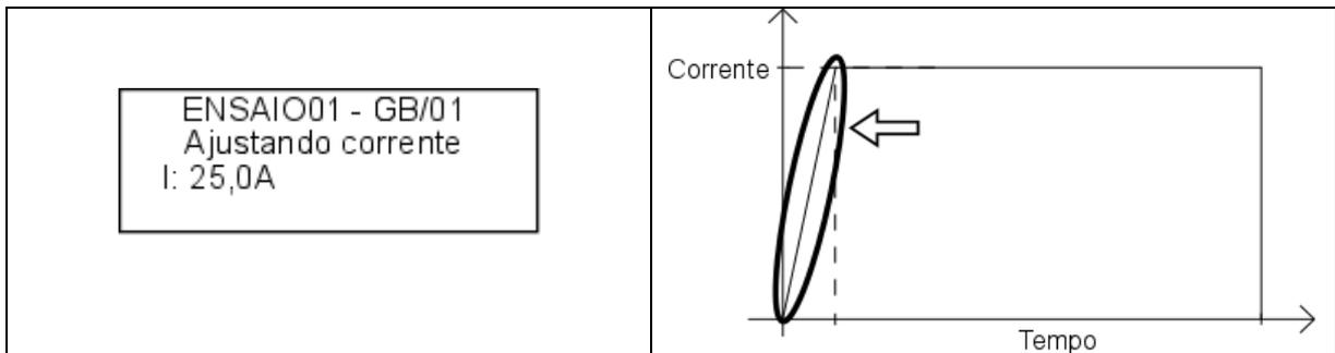
Quando a saída atinge o valor da corrente alvo, o GBT7200 mantém o valor da corrente durante o tempo configurado.
