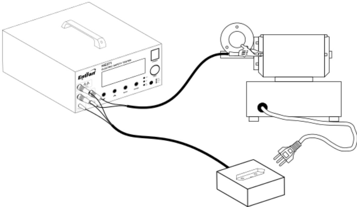
Para ensaio de equipamentos que possuam plugue de alimentação, conectar o plugue de alimentação à tomada de ensaio e a garra de jacaré à carcaça do equipamento.
