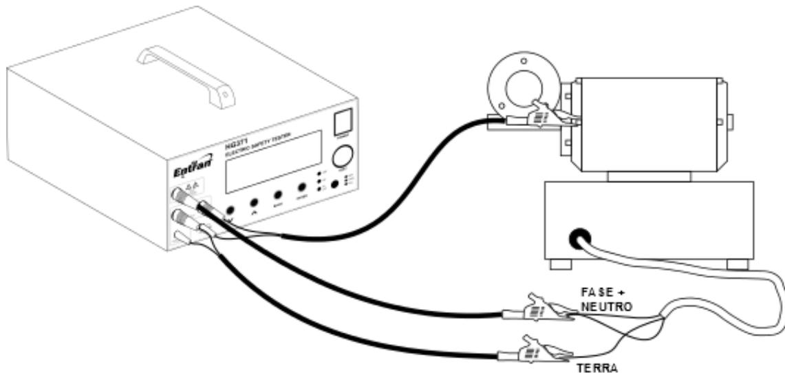
Equipamentos que não possuam plugue de alimentação NBR ou possuam outros padrões de plugues, utilizar o ensaio conforme a figura acima.
