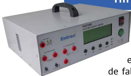
O HGI7000 foi projetado para atender fabricantes de equipamentos eletromédicos e prestadores de serviço, realizando ensaios de segurança elétrica de maneira automatizada. Ele permite a programação de diversos ensaios, facilitando o trabalho do operador e diminuindo a probabilidade de falhas. Os resultados podem ser armazenados em um computador na forma de relatório, contendo todas as informações relevantes para manter a documentação conforme exigido pelos órgãos reguladores.
